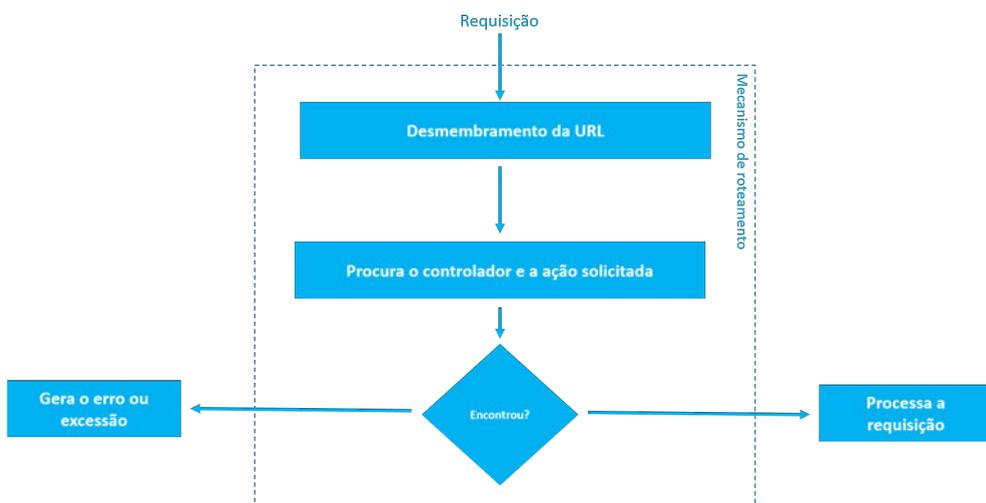
Figura 2.3: Esquema do mecanismo de rotas do ASP.NET MVC
