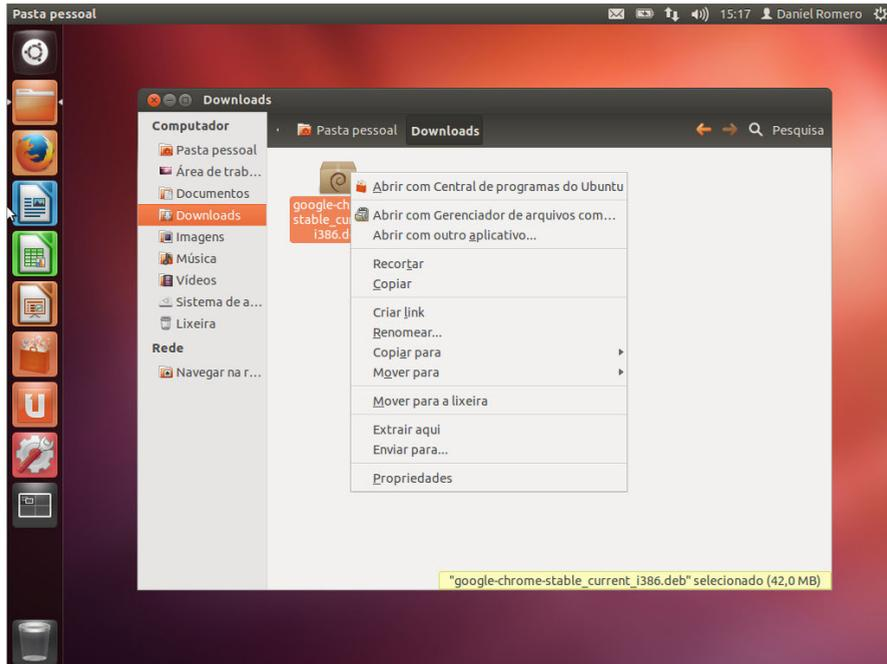
Figura 7.2: Instalando o pacote usando o gerenciador gráfico
